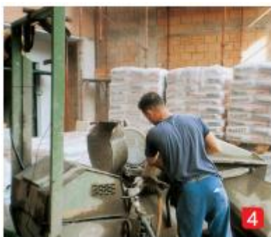
4) Příprava hmoty v kontinuální míchačce.
